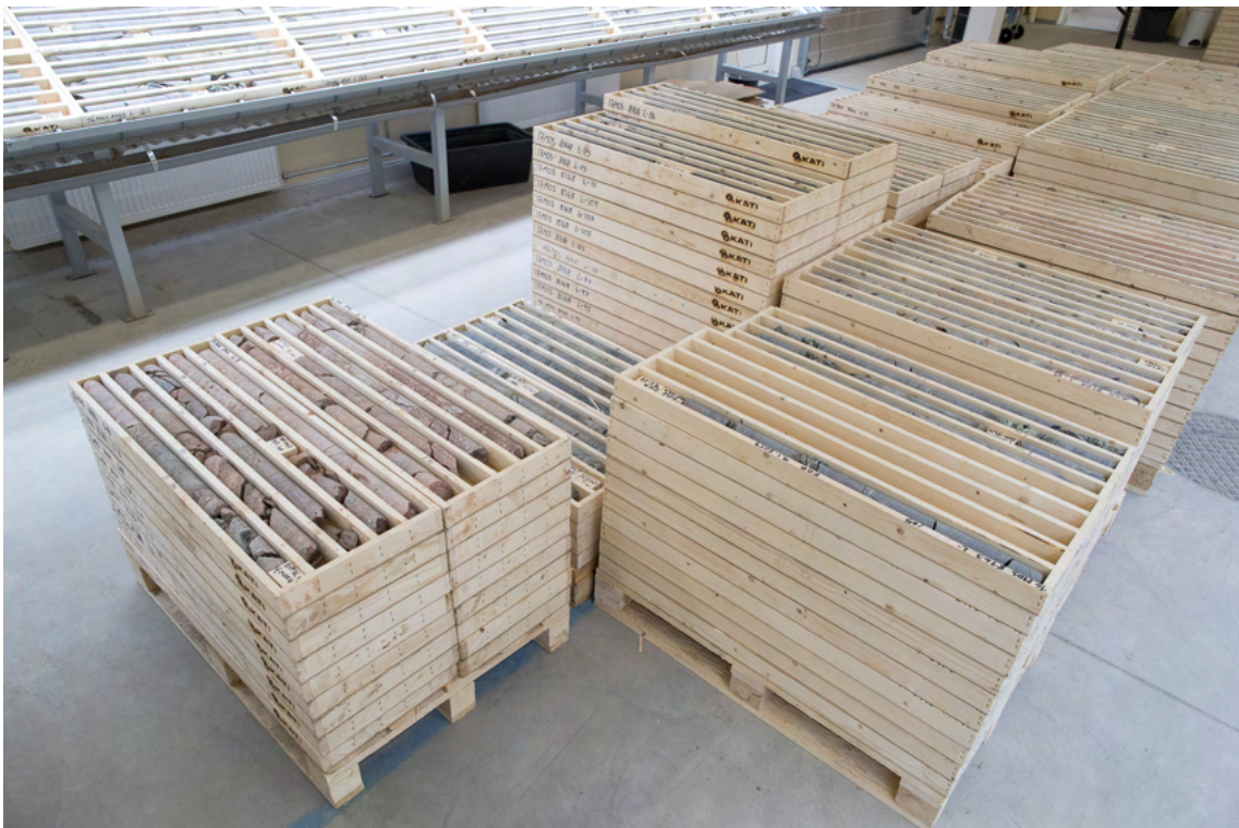
Vastakairattuja kairasydäntäytteitä lavoilla. Kuva: AA Sakatti Mining Oy.
