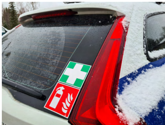
Jokaisessa työmaa-ajoneuvossa tulee olla palosammutin ja ensiapulaukku. Kuva: Oy Kati Ab.
